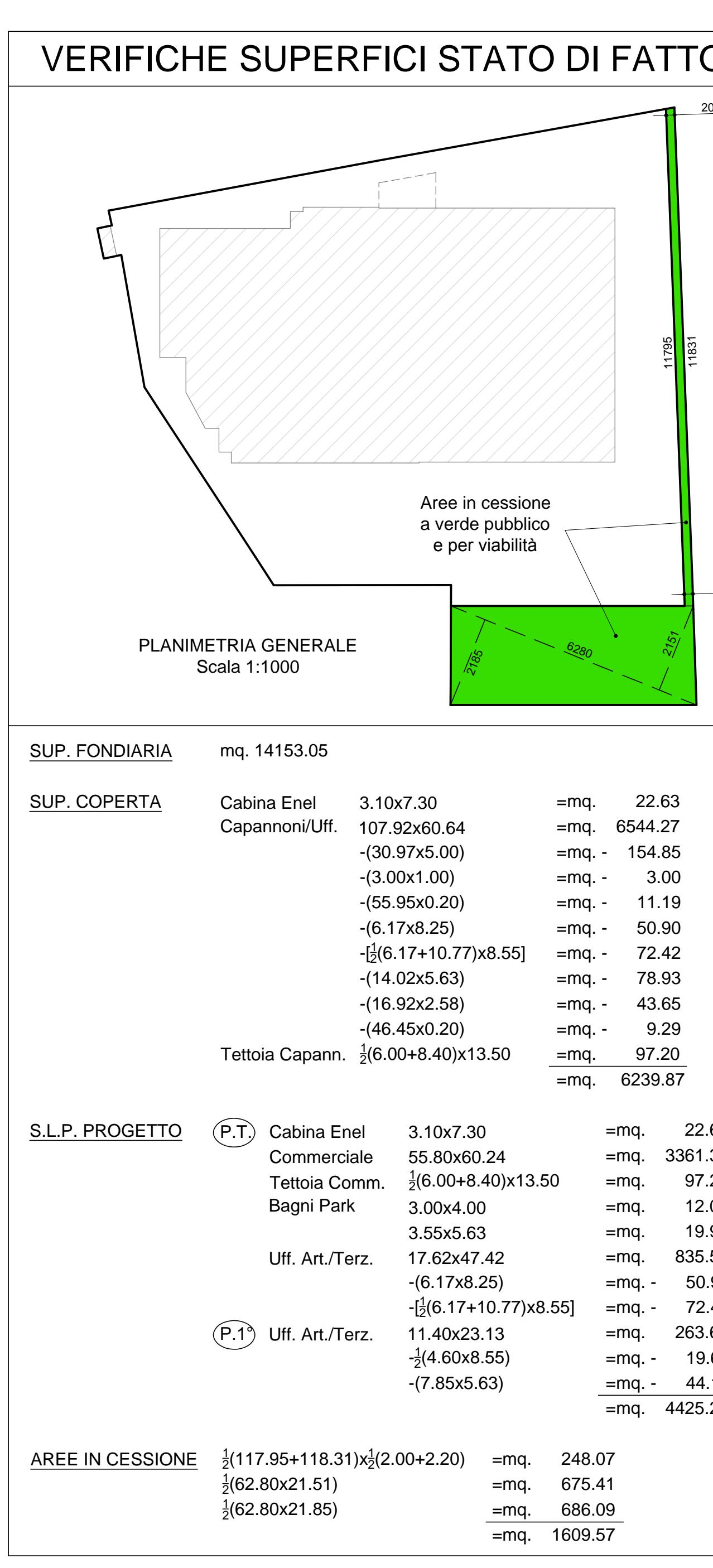
**PLANIMETRIA GENERALE E PIANTA PIANO TERRA (in progetto)**
