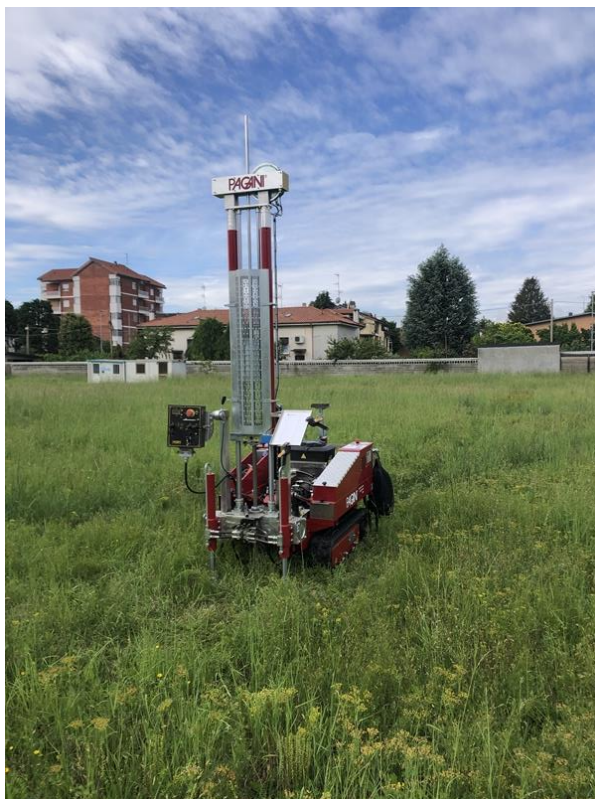
Foto 3: Esecuzione Prova Penetrometrica n.3
