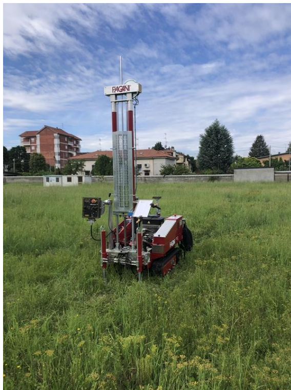
Foto 3: Esecuzione Prova Penetrometrica n.3
