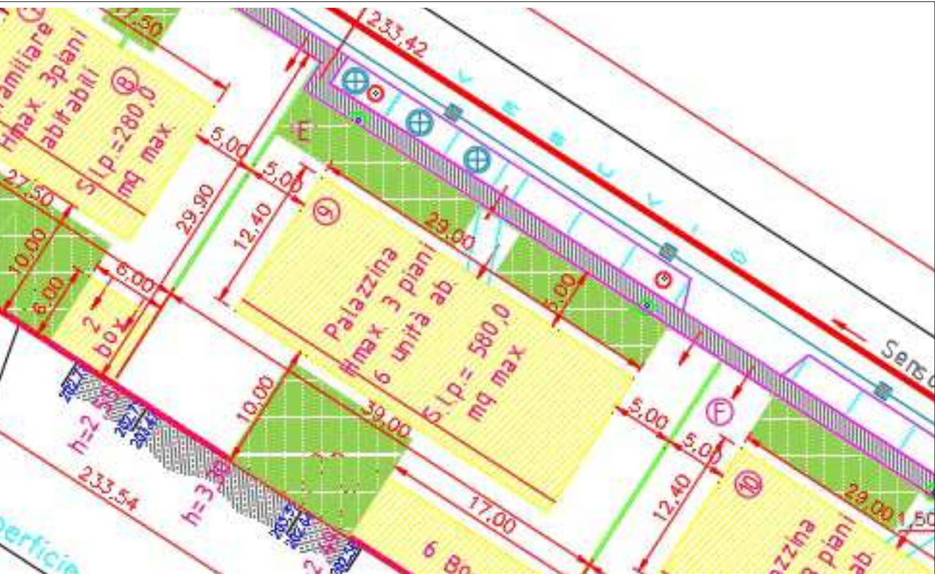
POZZI PERDENTI - VIA VESUVIO \phi=1.5\text{m} H=3.5\text{m} s=50\text{ cm}
